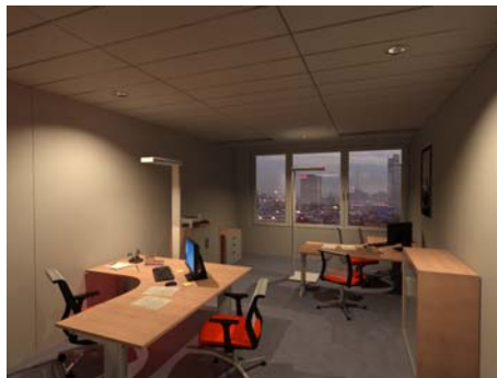
200 lux éclairage général (LED) Jusqu'à 500 lux poste de travail (LED) Flexibilité totale et contrôle par l'utilisateur
