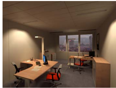
200 lux éclairage général (LED) Jusqu'à 500 lux poste de travail (LED) Flexibilité totale et contrôle par l'utilisateur
